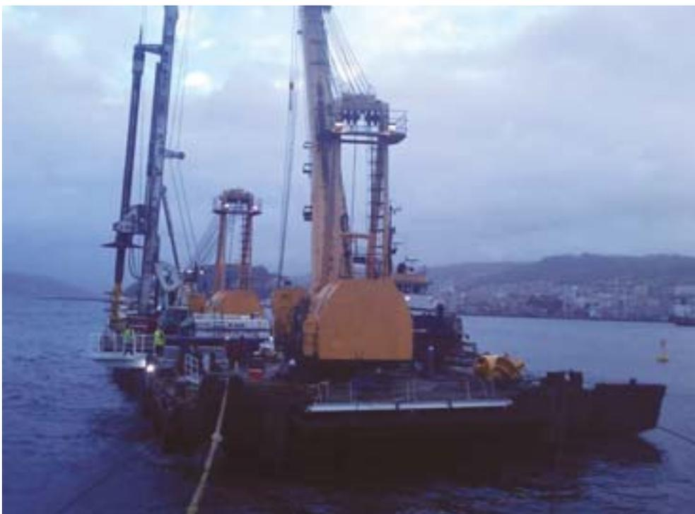
FIGURA 19. Perforadora posicionada para perforar por el interior del tubo.
