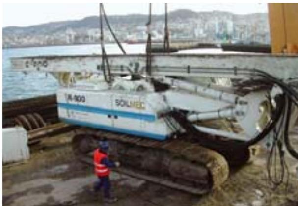
FIGURA 18. Perforadora en transporte en la pontona.
