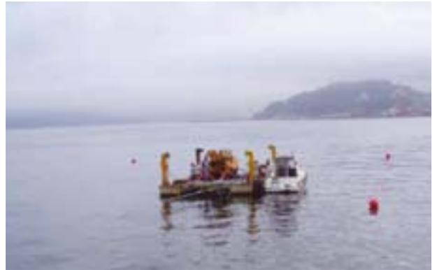
FIGURA 7. Pontona con equipo de sondeos.
