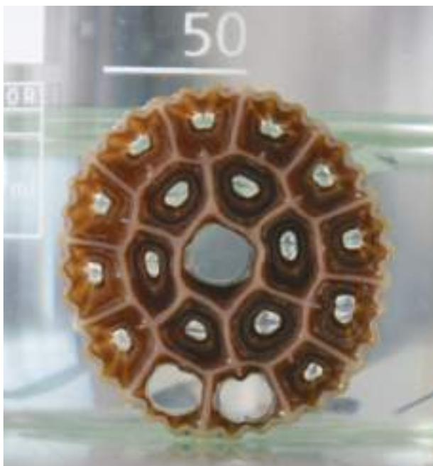
FIGURA 3. Aspecto de la biopelícula adherida al material de relleno.
