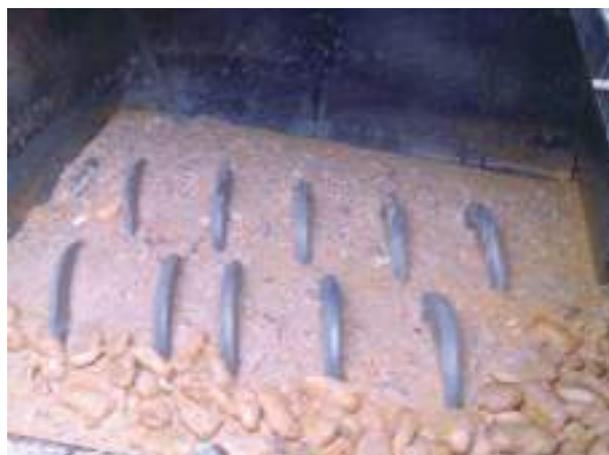
FIGURA 3. Trituración y acondicionamiento residuo sólido (Sistema ECRUSOR, Veolia).
