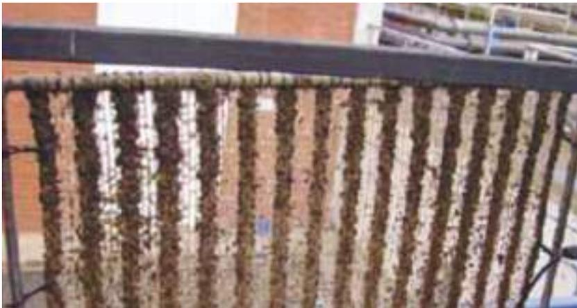
FIGURA 7. Detalle de la fibra textil soporte de biomasa.
