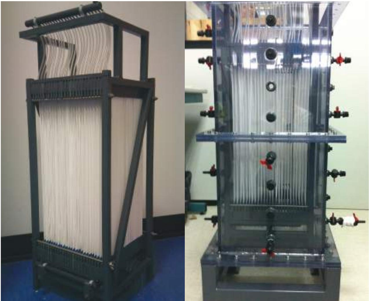
FIGURA 7. Módulo RBSOM para la investigación de configuraciones híbridas.
