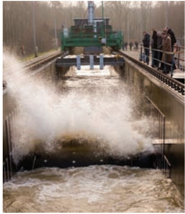
FIGURA 15. Impacto de las olas en los tubos durante las pruebas del canal. / FIGURE 15. Wave impact on tubes during flume tests.
