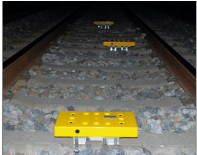
**Figura 19.** Grupo de tres balizas con la central desplazada hasta  $240\text{ mm}$ .
