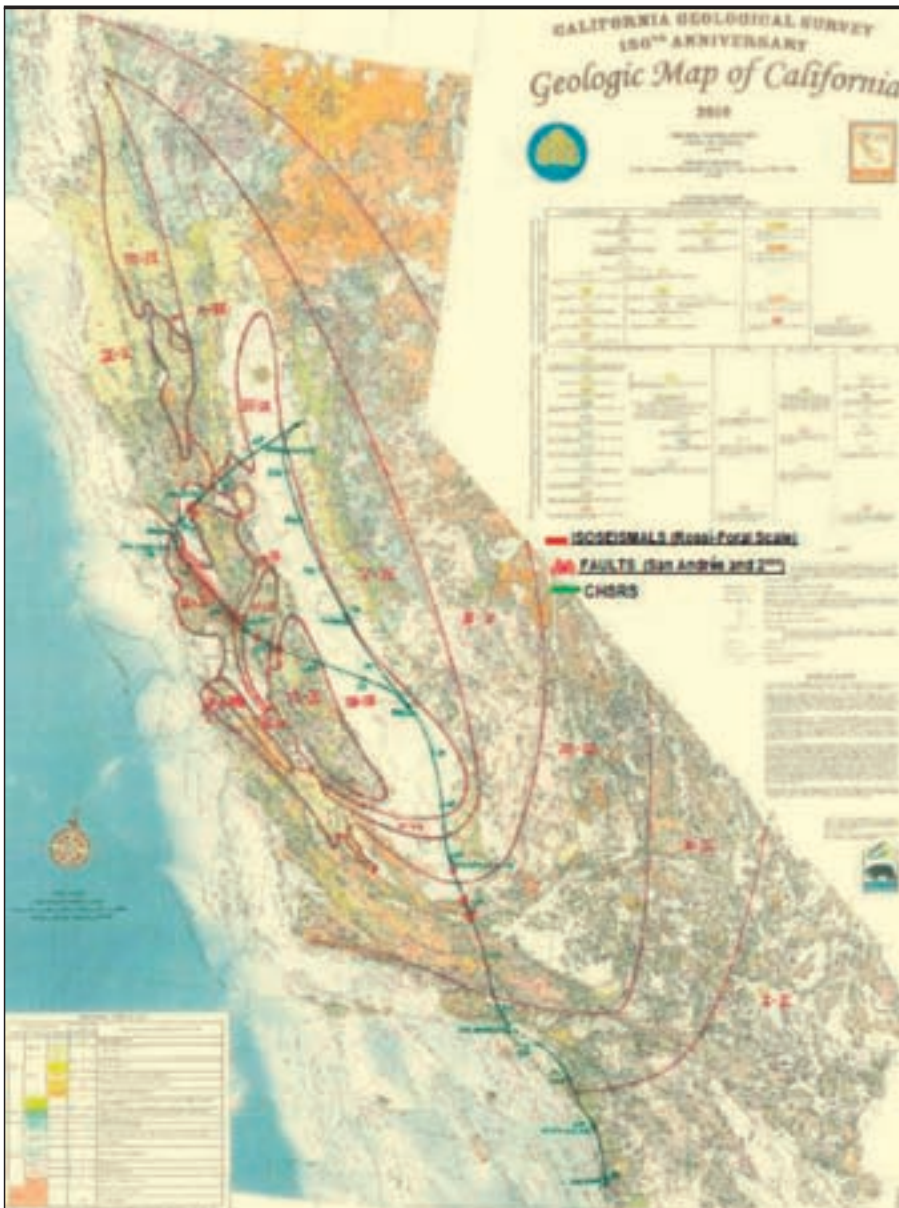
FIGURA/E 13. Planta Geológica general con líneas isosismas en el Trazado del Proyecto FARWEST / General Geological ground plan with seismic intensity line on the FARWEST Project.
