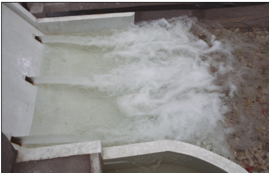
Figura 7. Modelo de la presa de Entrepeñas. Situación actual. Desagües de fondo con caudal máximo.
