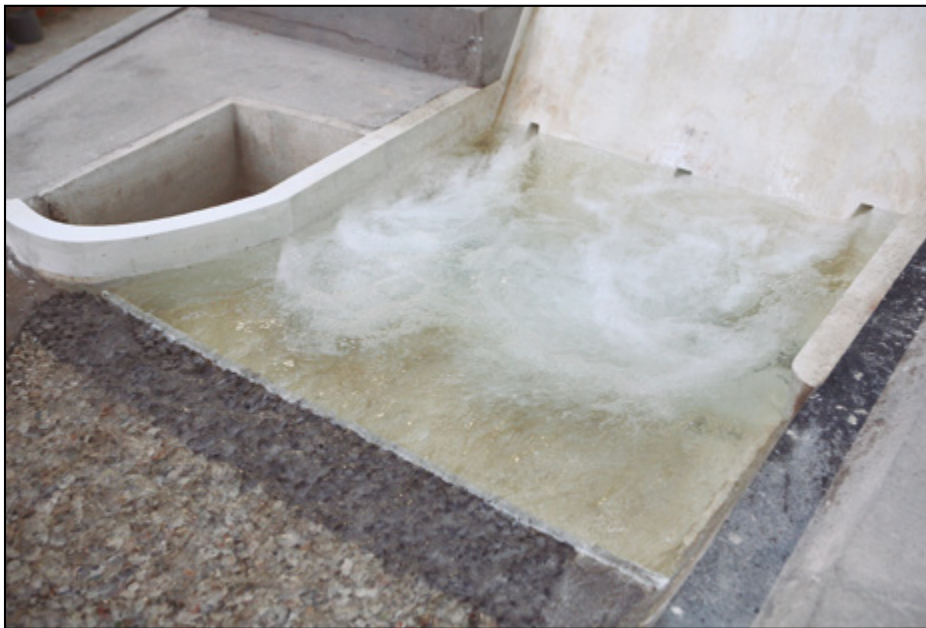
Figura 9. Modelo de la presa de Entrepeñas. Solución propuesta. Desagües de fondo con caudal correspondiente a 96 \text{ m}^3/\text{s} por desagüe.
