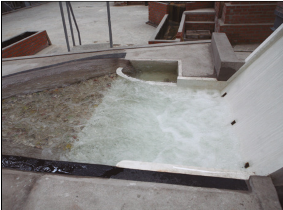
Figura 6. Modelo de la presa de Entrepeñas. Situación actual. Vertido por aliviadero de la avenida de proyecto (683,52 m 3 /s).
