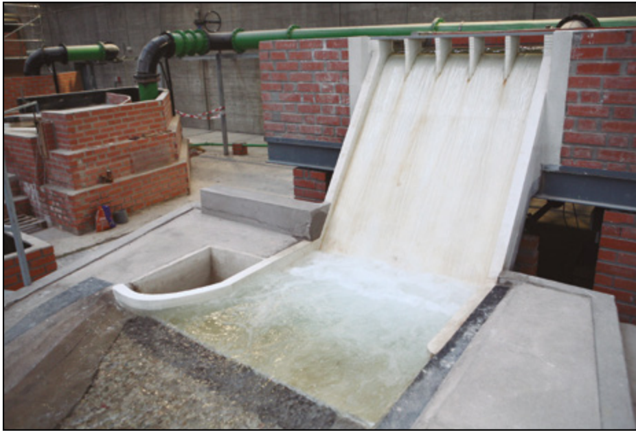
Figura 8. Modelo de la presa de Entrepeñas. Solución propuesta. Vertido por aliviadero de la avenida de proyecto ( 683,52 \text{ m}^3/\text{s} ).
