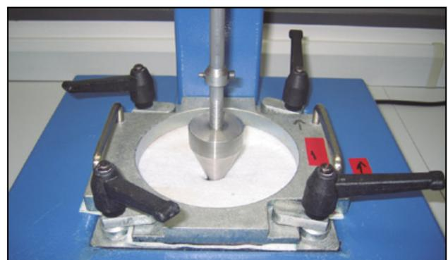
**Figura 20.** Detalle del ensayo de resistencia a la perforación por caída de cono.
