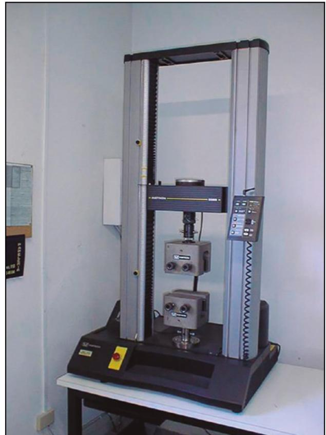
Figura 16. Dinamómetro para la determinación de la resistencia a tracción y alargamiento.
