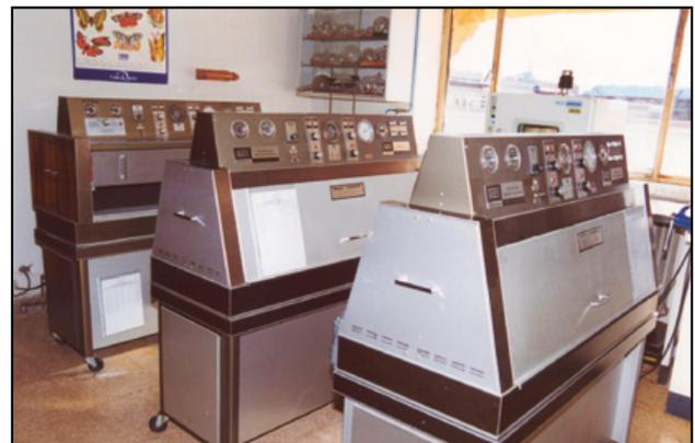
Figura 21. Ensayo de resistencia a la intemperie.
