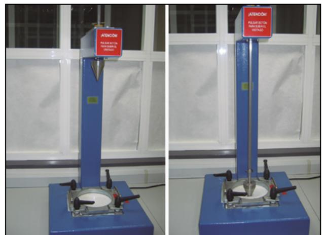
**Figura 19.** Ensayo de resistencia a la perforación por caída de cono.
