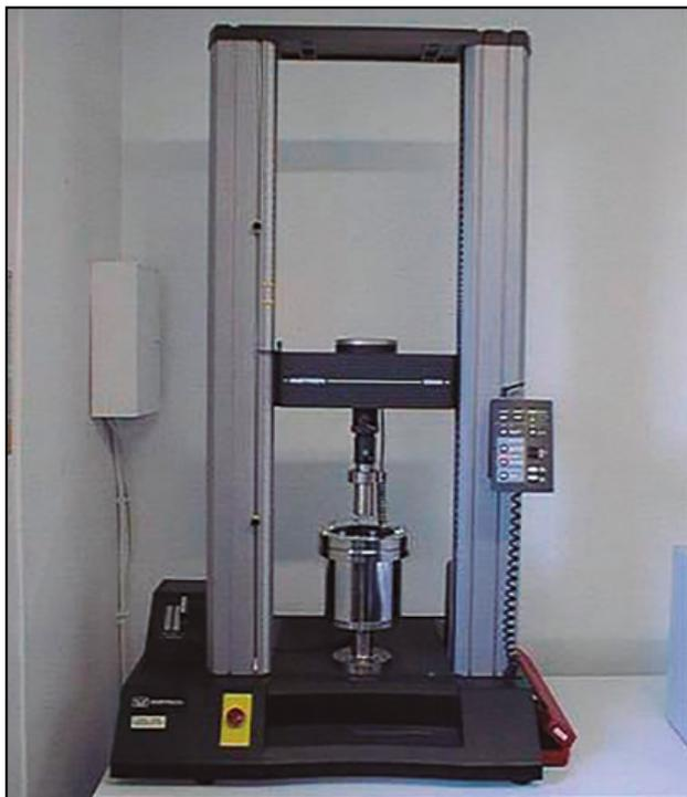
**Figura 18.** Dinamómetro con el dispositivo para el ensayo de resistencia a punzonamiento estático.
