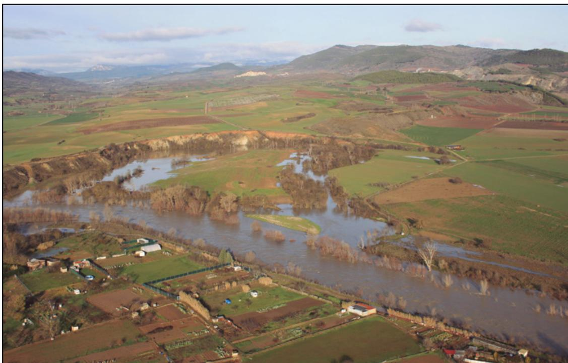
**Figura 3.** Funcionamiento del meandro del Plantío en el río Arga (Navarra), durante una crecida ordinaria posterior a la ejecución del proyecto de reconexión hidráulica, morfológica y ecológica desarrollado (imagen de enero de 2010) (Fuente: Gobierno de Navarra).
