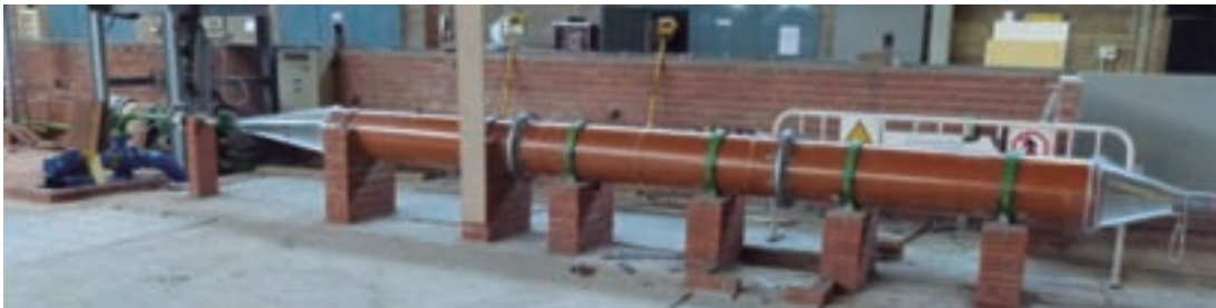
FIGURA 5. Aspecto del permeámetro en las primeras fases de ensayo. La parte central es de PVC y las presiones se miden mediante tubos piezométricos.
