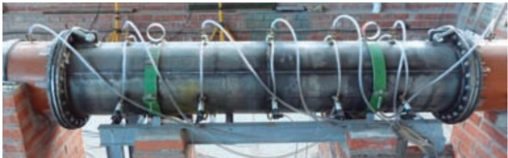
FIGURA 6. En una segunda fase se sustituyó el tubo de muestra por uno de acero inoxidable, se aumentaron los puntos de medida y se colocaron captadores automáticos de presión.
