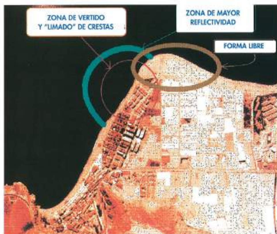
FIGURA 15. Zona de vigilancia recomendada. Se indica la zona peligrosa, candidata a sufrir fenómenos de resonancia debido a sus condiciones de reflectividad. Se indica asimismo la delimitación aproximada de la forma libre.
