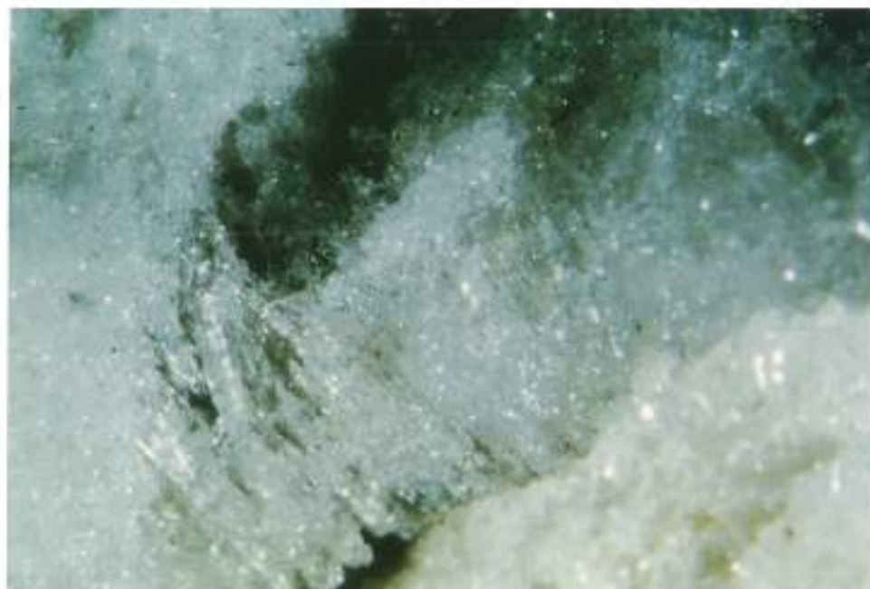
FOTO 7. lupa binocular (25 aumentos). Detalle de las sales de Mg donde se observa su desarrollo en cristales fibroso-radiales.
