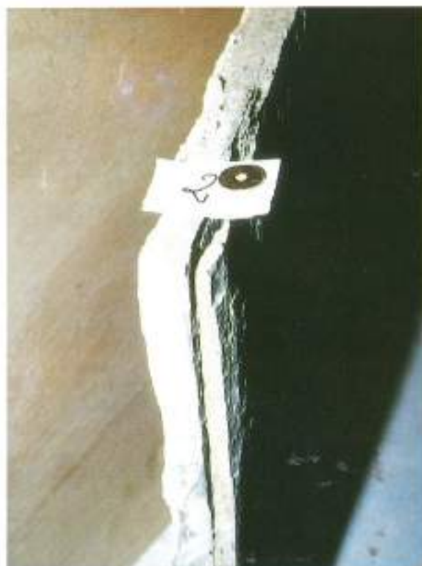
FOTO 8. El sulfato de calcio (yeso) cristalizó hacia el interior de la pizarra provocando en ocasiones el levantamiento de placas.
