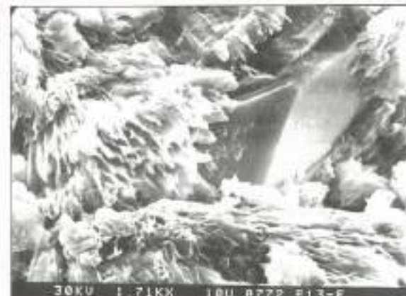
D. Desarrollo, por cristalización de sales ( \text{SO}_4\text{Na}_2 ), en el interior del material, sobre cristales de cuarzo, como se puede apreciar tienen una estructura esponjosa.
