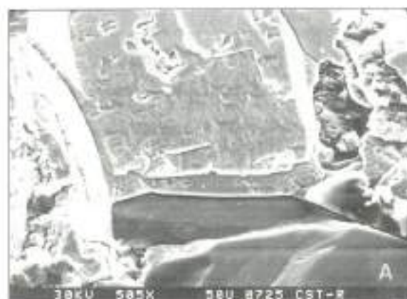
A. Cristal de hialofana ( \text{Si}_2\text{O}_5\text{Al}_2\text{Ba} ), idiomórfico, con disoluciones selectivas superficiales.
