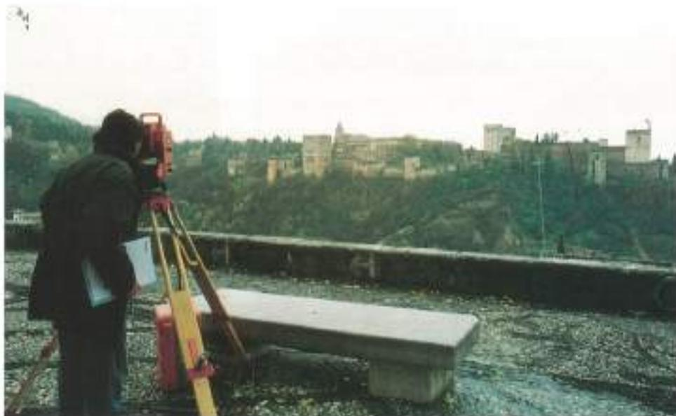
FOTO 4. Control mediante topografía de precisión de la coronación del Tojo de San Pedro.
