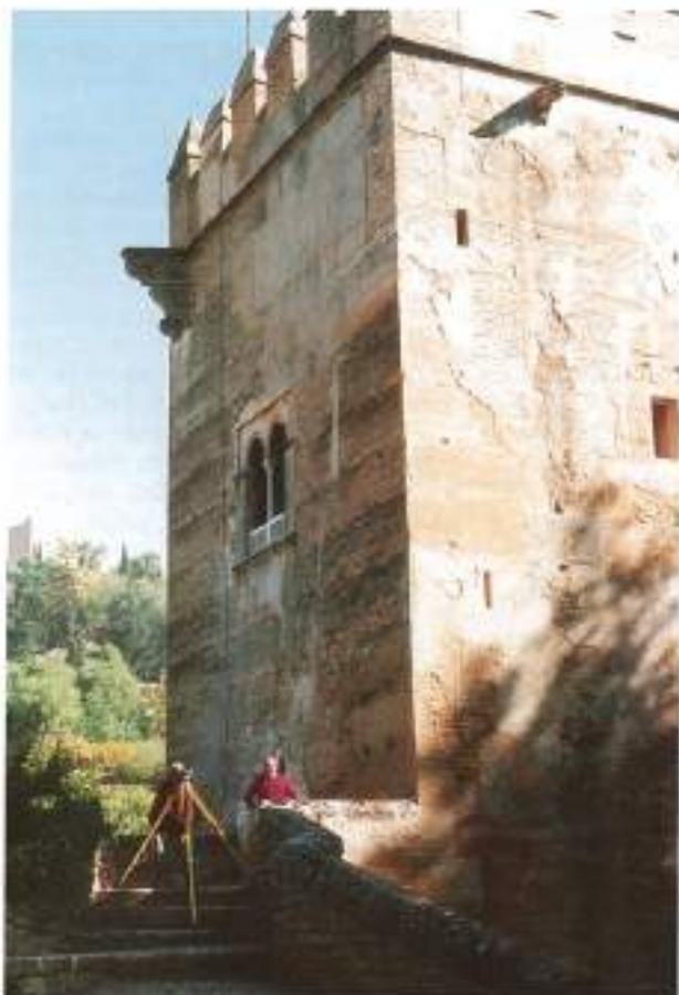
FOTO 8. Determinación de desplomes en la Torre de los Picos, mediante plomada óptica.
