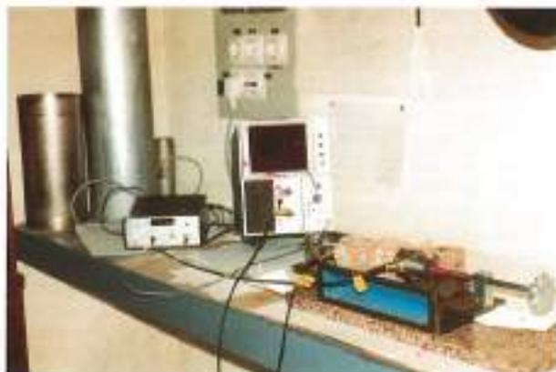
FOTO 14. Medida de velocidades sísmicas en un testigo de topial.
