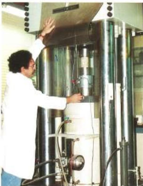
FOTO 15. Rotura controlada de un testigo de topial.
