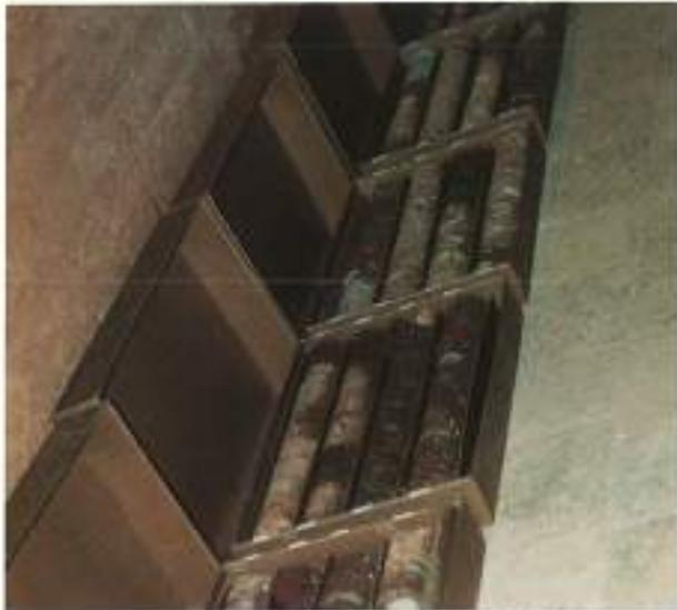
FOTO 11. Testigos de sondeo en el tapial de cimiento de la Torre de Comares.
