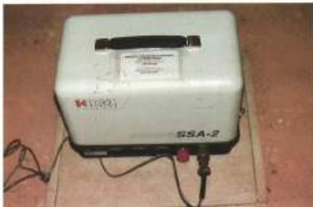
FOTO 12. Acelerógrafo instalado en la torre de Comares.
