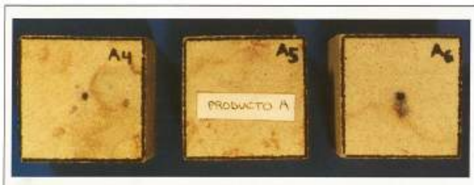
FOTO 13. Probetas realizadas para la determinación de las propiedades físicas y los ensayos de envejecimiento acelerado.
