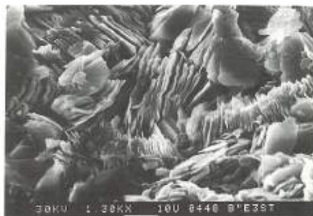
FOTO 6. Coqueolitas de neoformación en arenisca de monumento.
