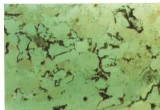
FOTO 5. Óxidos de hierro recubriendo los granos minerales.
