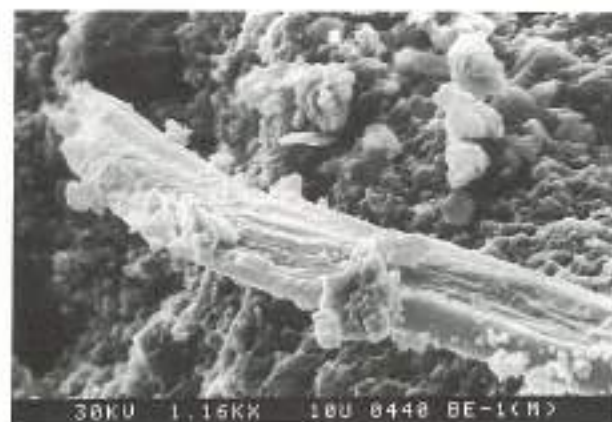
FOTO 7. Cristal de yeso neoformado en arenisca de monumento.
