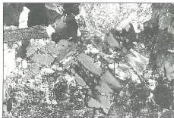
FIGURA 9. Fotomicrografía de Adameilita biotítica. Se aprecian los Cuarzos (blancos), Feldespatos (gris turbio), Plagioclasas con maclas poissintéticas (listado blanco y negro) y Biotitas (amarillentas).
