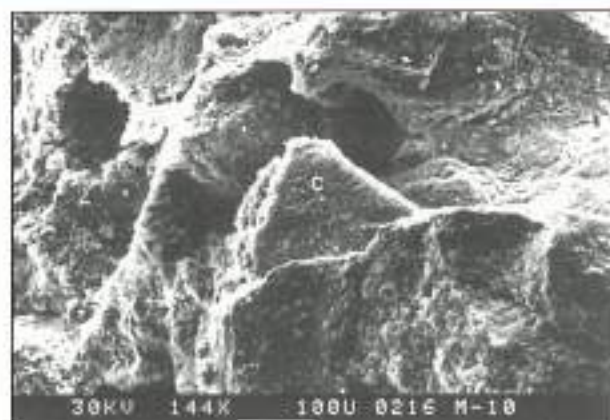
FOTO 2. Cristales de calcita (C) en una muestra de mortero de cal.
