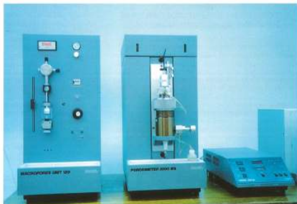
FOTO 1. Equipo para la realización del ensayo de porosimetría por intrusión de mercurio.
