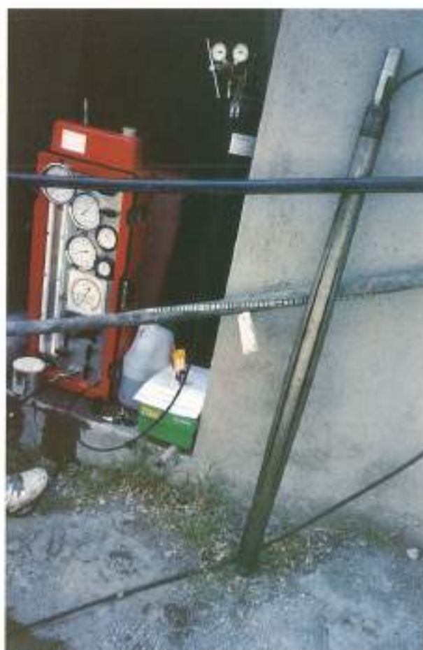
FOTO 2. Central Presiométrica GEOMATECH CPV-200. Tuba ranurada de 60 mm durante medida de la inercia de la sonda.
