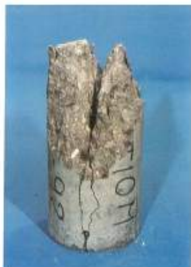
FOTOGRAFÍA 4. Descabezamiento con hendimiento.
