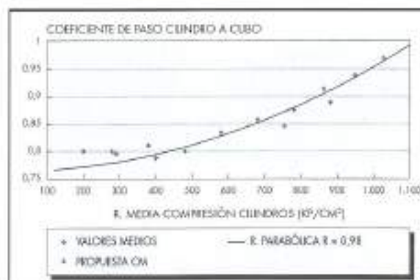
FIGURA 10. Paso de cilindro a cubo según nivel de resistencia.
