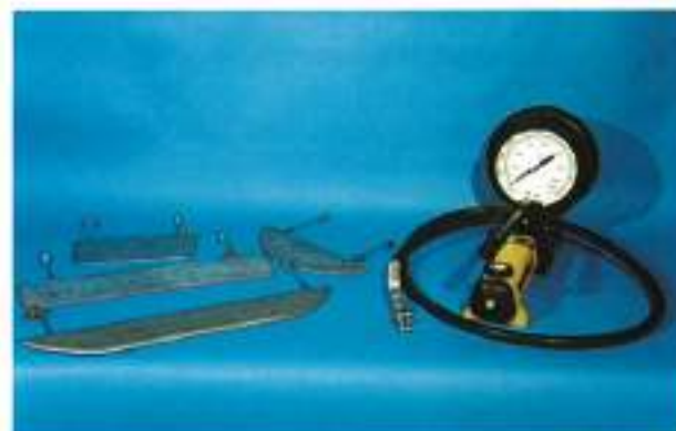
FIGURA 2. Equipo de ensayo de gato plano del laboratorio Central de Estructuras y Materiales.
