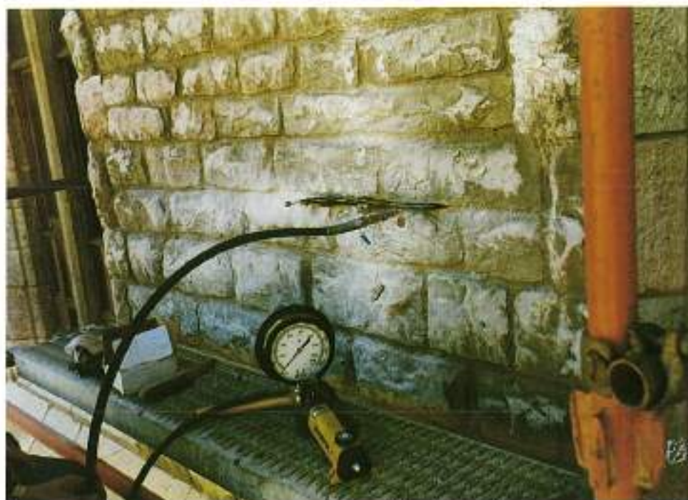
FIGURA 7. Estimación del estado tensional en el Palacio Botines mediante gato plano.
