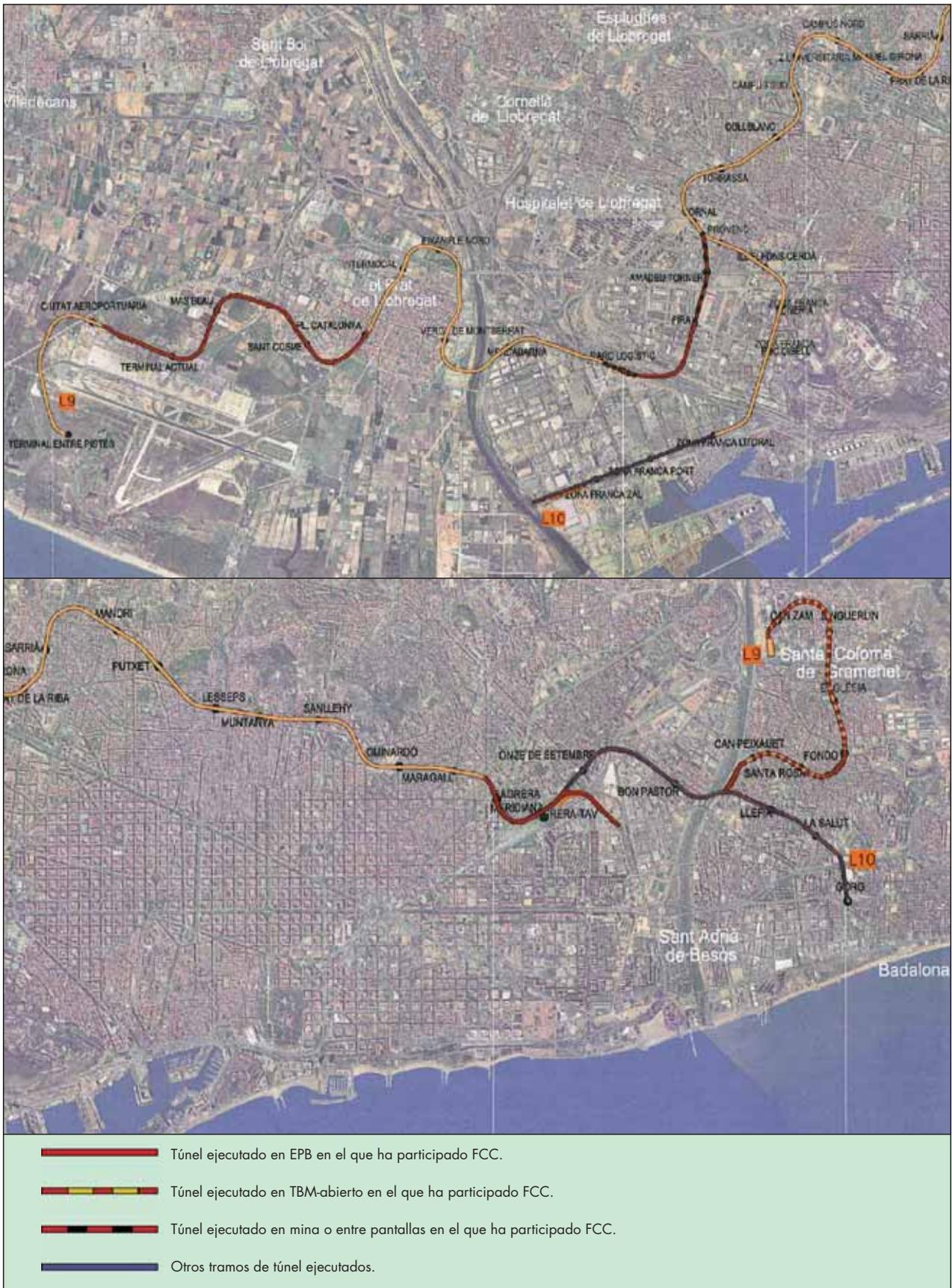
FIGURA 1. Planta de la Línea 9 del Metro de Barcelona. Tramos de túnel de la L9 ejecutados o en ejecución por FCC Construcción, en diciembre de 2008.
