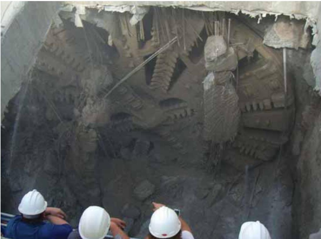
FIGURA 6. Máquina EPB de 9.40 m "Guster" (UTE Túnel Aeroport). Cale en Terminal Actual.
