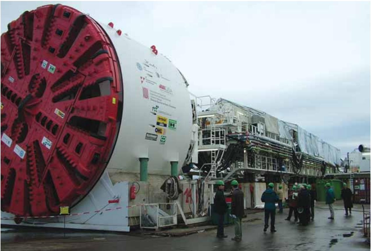
FIGURA 5. Máquina EPB de 9.40 m "Hades" (UTE Fira y UTE Túnel Aeroport).
