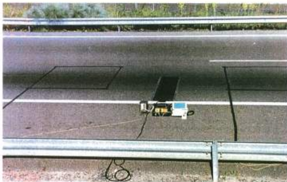
FOTO 1. Disposición del equipo de pesaje en la carretera.
