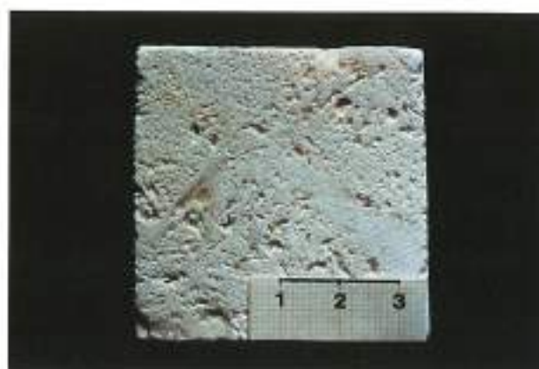
FIGURA 1. Aspecto de visu de la caliza de Hontoria de cantera.
