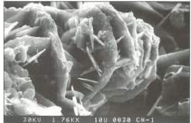
FIGURA 19. Imagen S.E.M. de cristales de yeso precipitados en la superficie de la costra negra.
