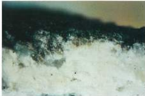
FIGURA 18. Aspecto en corte transversal de la costra negra (longitud aproximada de la figura, 3 cm).
