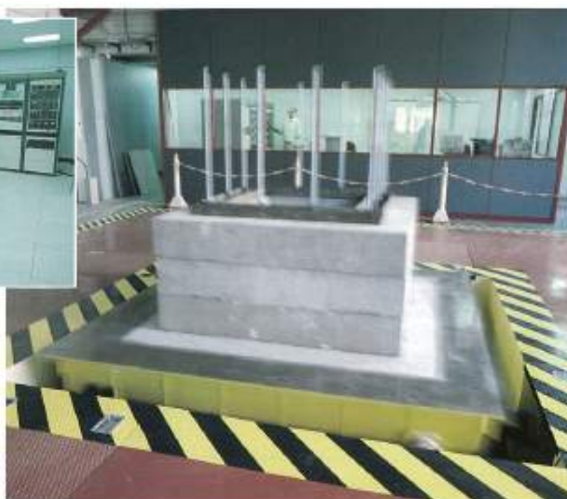
FOTOGRAFÍA 3. Ensayos de recepción con un modelo rígido de 6 Tn de masa.
