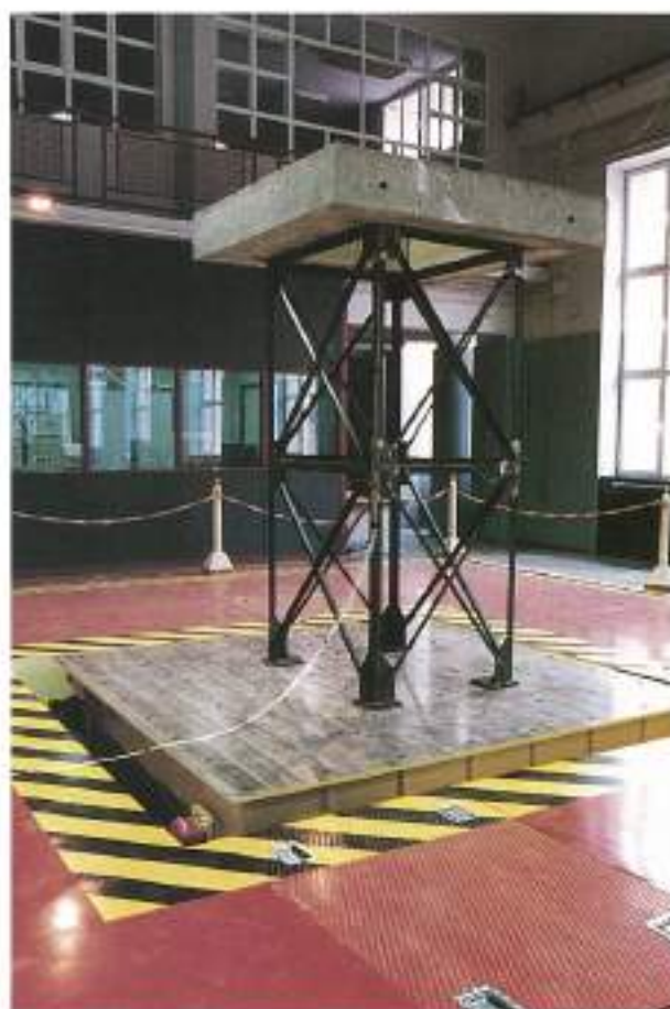
FOTOGRAFÍA 1. Simulador sísmico de 6 grados de libertad del Laboratorio Central de Estructuras y Materiales del CEDEX (MOPTMA).
