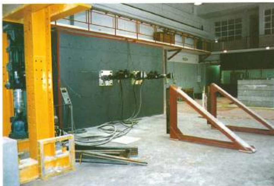
FIGURA 4. Vista general del equipo de realización de ensayos pseudodinámicos.
