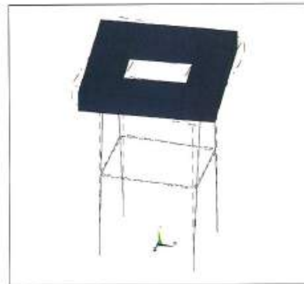
FIGURA 10. Tercer modo de vibración.
