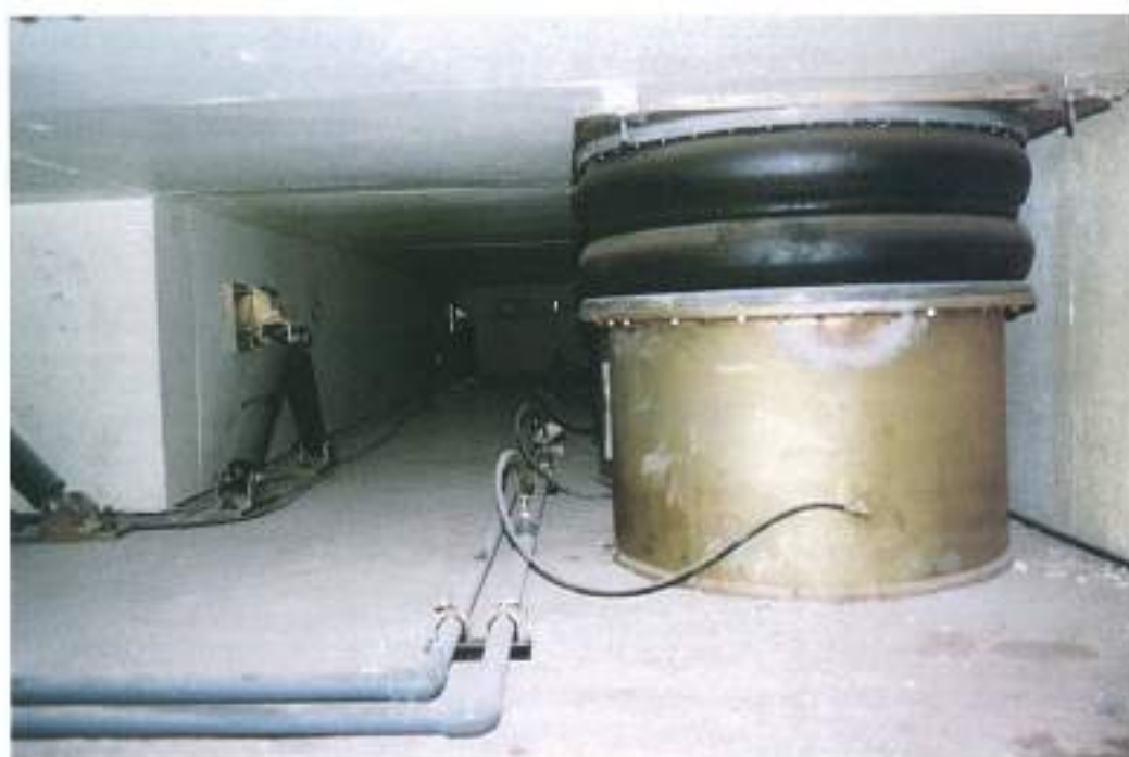
FIGURA 2. Soporte de la masa de reacción mediante cojines neumáticos y amortiguadores.
