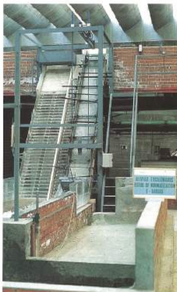
FOTO 4. Modelo para estudios de normalización. Rápidas en régimen confinado y libre.
