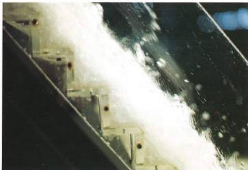
FOTO 6. Régimen deslizando (Skimming flow).
