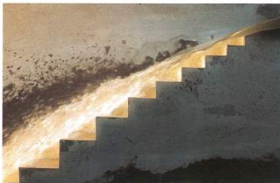
FOTO 2. Presa de Sierra Brava. Modelo a escala 1/4.
