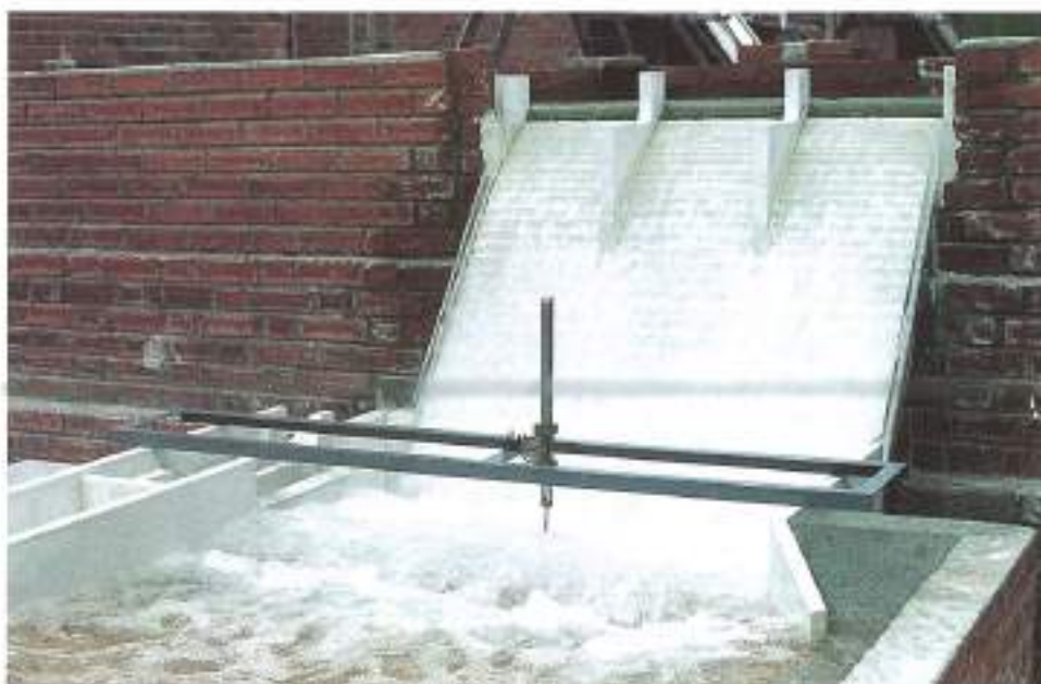
FOTO 3. Presa de Alcollarín. Modelo a escala 1/25.
