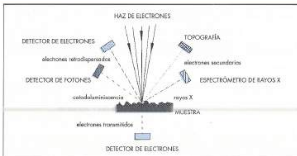
FIGURA 1. Distintos tipos de señales emitidas por una muestra cuando es bombardeada por un haz electrónico y sus correspondientes aplicaciones.
