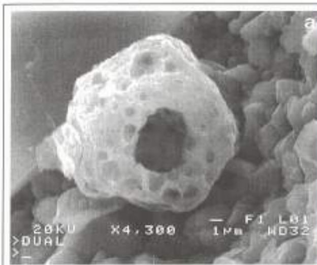
FIGURA 5. Catedral de Burgos. a) Partícula subsférica con abundantes poros, localizada en una costra. b) Su espectro EDX, caracterizado por la presencia de plomo y en menor grado de zinc, acompañadas por otros elementos. Procede de la combustión de gasolinas (Van Borm et al., 1989).
