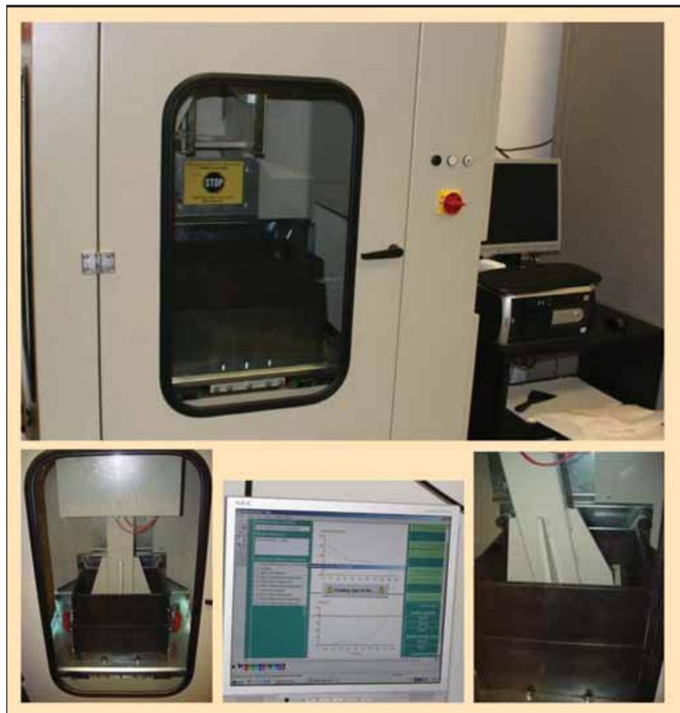
FIGURA 2. Dispositivo de compactación mediante rodillo de acero.
