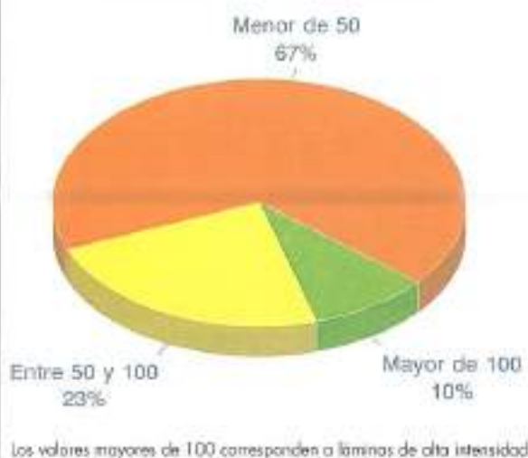
FIGURA 18: Valores del coeficiente de retrorreflexión en las señales de circulación, cuando presentaron el fenómeno de las condensaciones.
