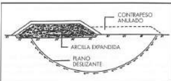
FIGURA 2. Relleno con arcilla expandida para aumentar la estabilidad en una calzada elevada sobre terreno pantanoso.
