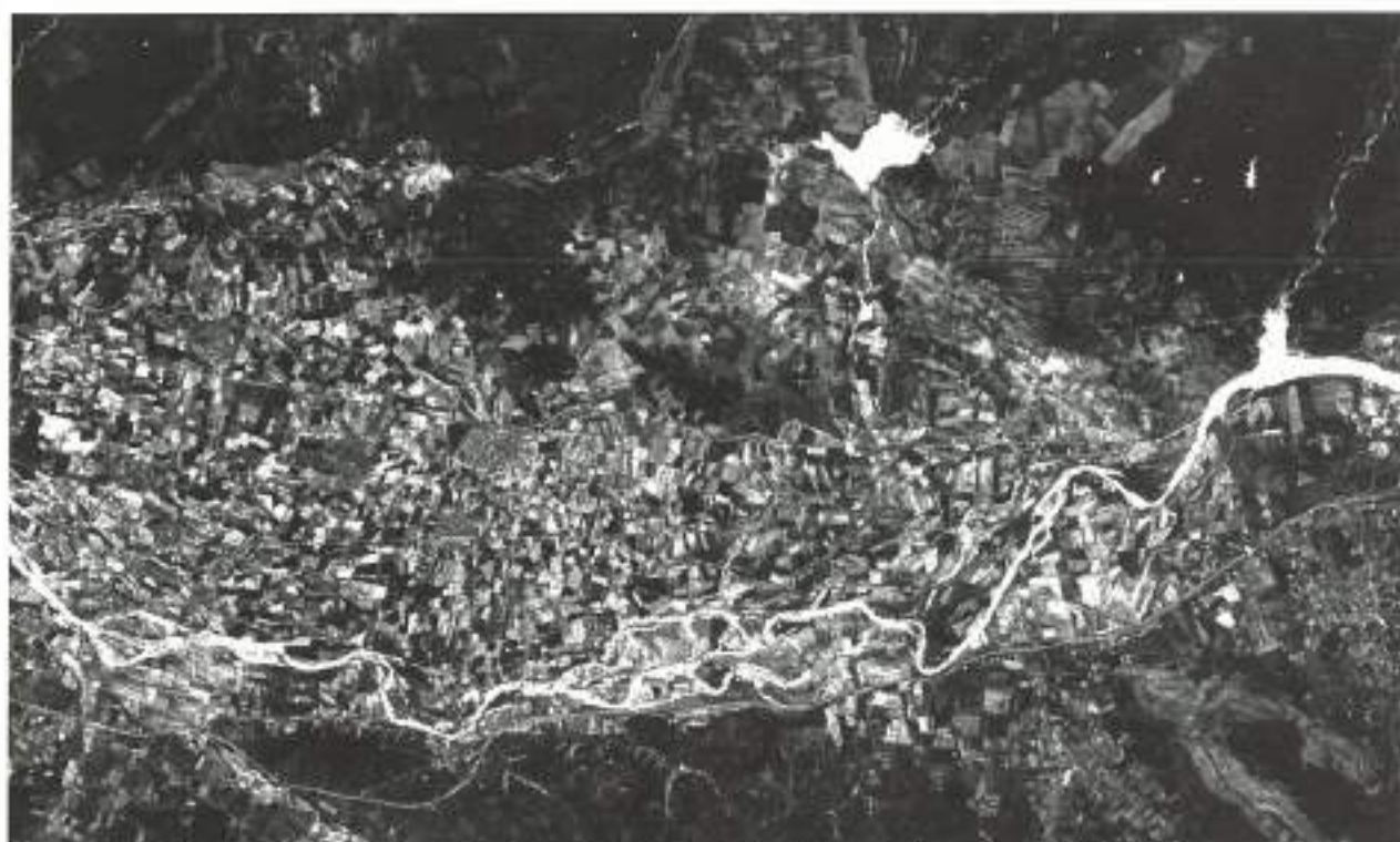
Imagen resultante de efectuar un cociente entre las bandas 1 y 5 (Vegas Bajas, Badajoz). Cuenca del Guadiana. [TM1/TM5].
