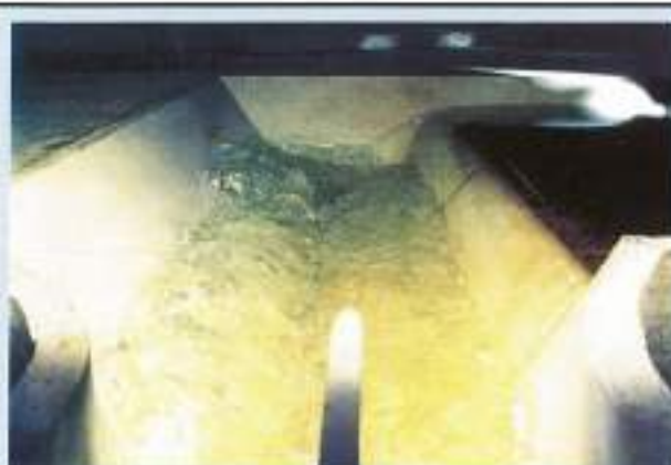
Solución inicial, Q = 600 \text{ m}^3/\text{s} . Vertedero y canal colector. Se aprecia gran agitación en el paramento opuesto al vertedero.
