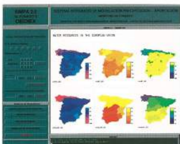
FIGURA 13. Ejemplo de cálculo de mapas de precipitación, ETP y escorrentía para la Península.
