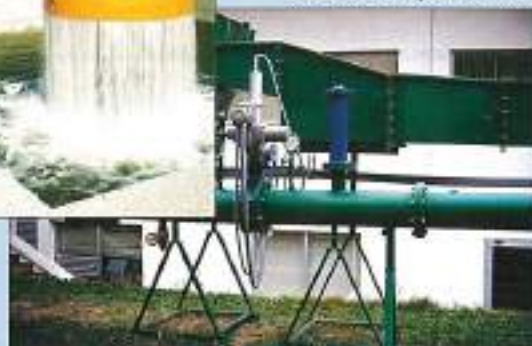
VÁLVULA REGULADORA DE PRESIÓN Y CAUDAL Y PURGADOR TRIFUNCIONAL Banco de Ensayos de EINAR
