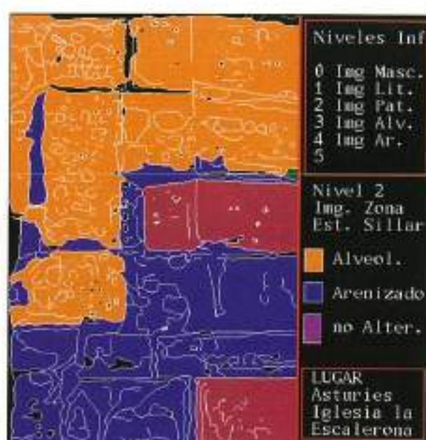
FOTO 10. Imagen de las patologías. Como en los casos anteriores, se le ha asignado, en el S.I.G. el nivel 2.
