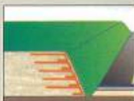
Refuerzo de taludes
