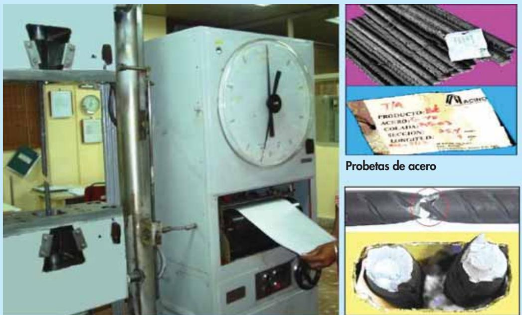
Máquina Universal de ensayo
