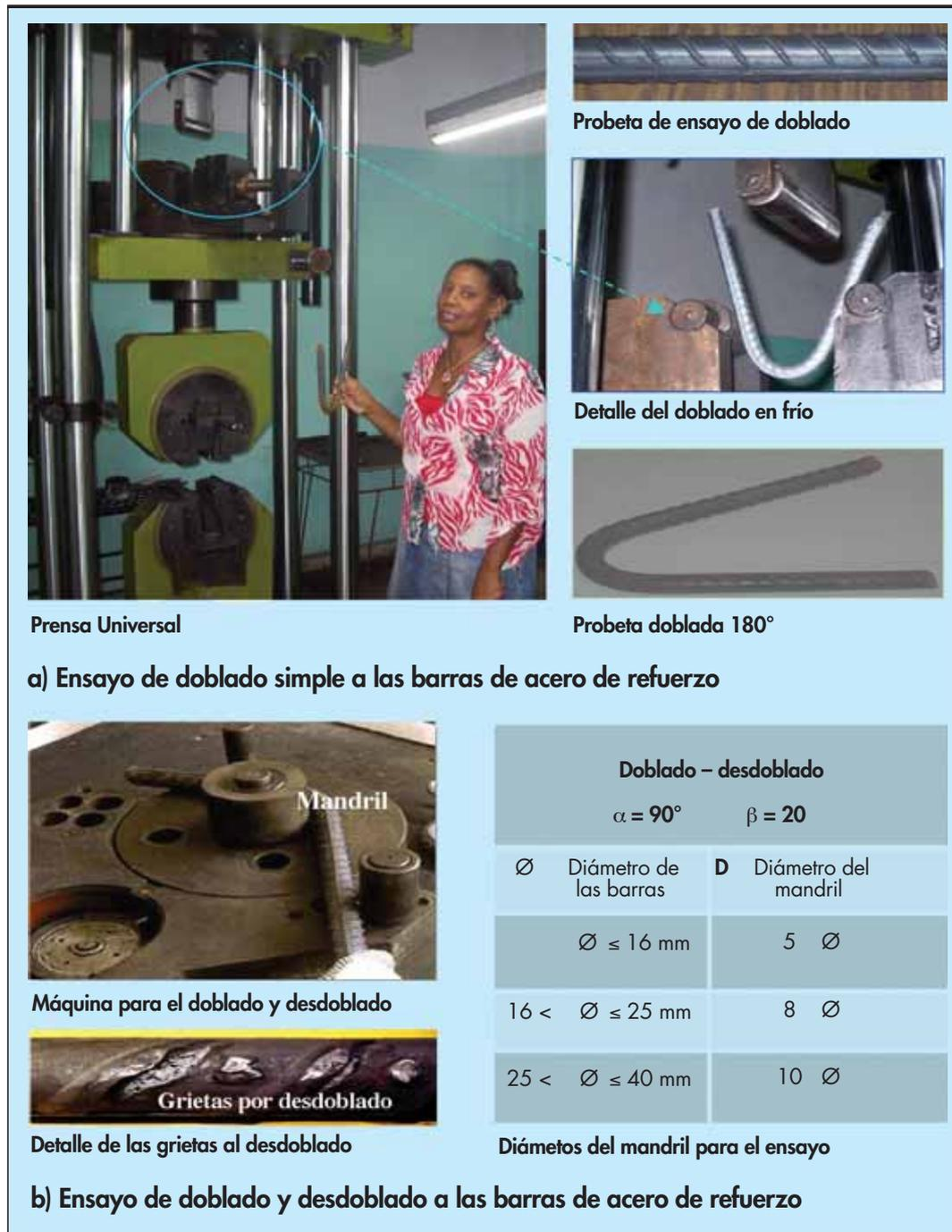
FIGURA 4. Ensayo de doblado a los aceros G-40 y G-60.
