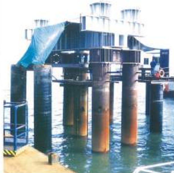
FIGURA 1a. Lisboa (Portugal, 1995). Vista general de un ensayo de carga de 2500 t., realizado sobre un pilote tubular abierto hincado, de 80 m y con un diámetro de 1200 mm, pertrechado de un extensómetro amovible LPC.
