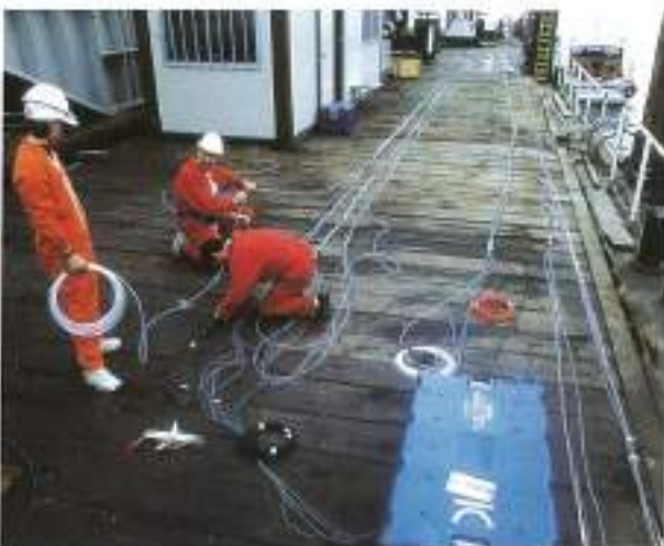
FIGURA 4. Vista de un extensómetro de 80 m ya ensamblado (Lisboa, Portugal, 1995).
