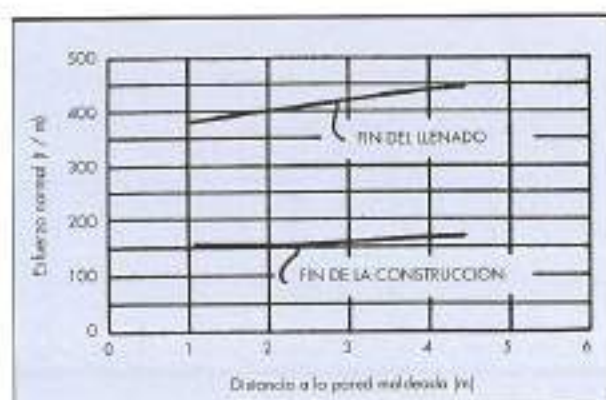
FIGURA 12. Esfuerzo normal en el plinto.
