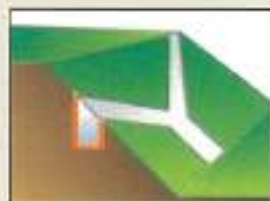
Drenaje de taludes
