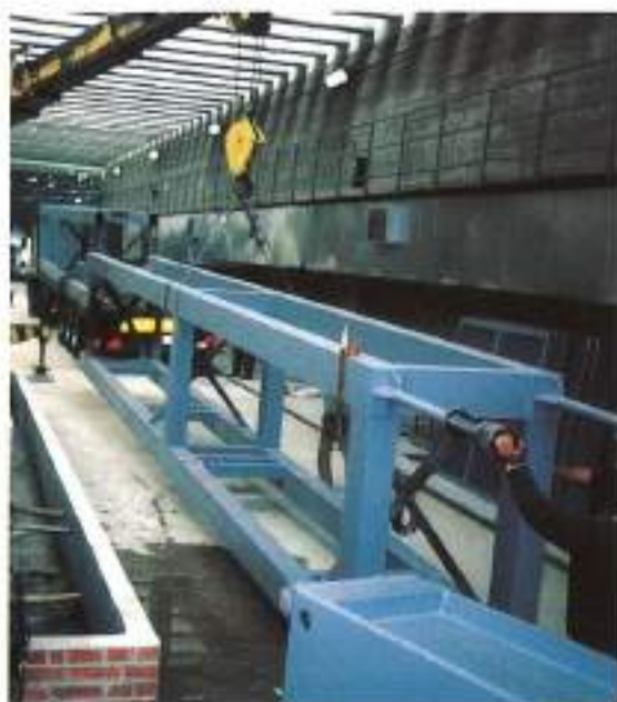
FOTOS 1 y 2. Montaje del banco de pruebas en el laboratorio de Hidráulica del Centro de Estudios Hidrográficos del CEDEX.
