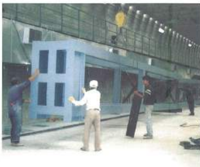
FOTOS 1 y 2. Montaje del banco de pruebas en el laboratorio de Hidráulica del Centro de Estudios Hidrográficos del CEDEX.
