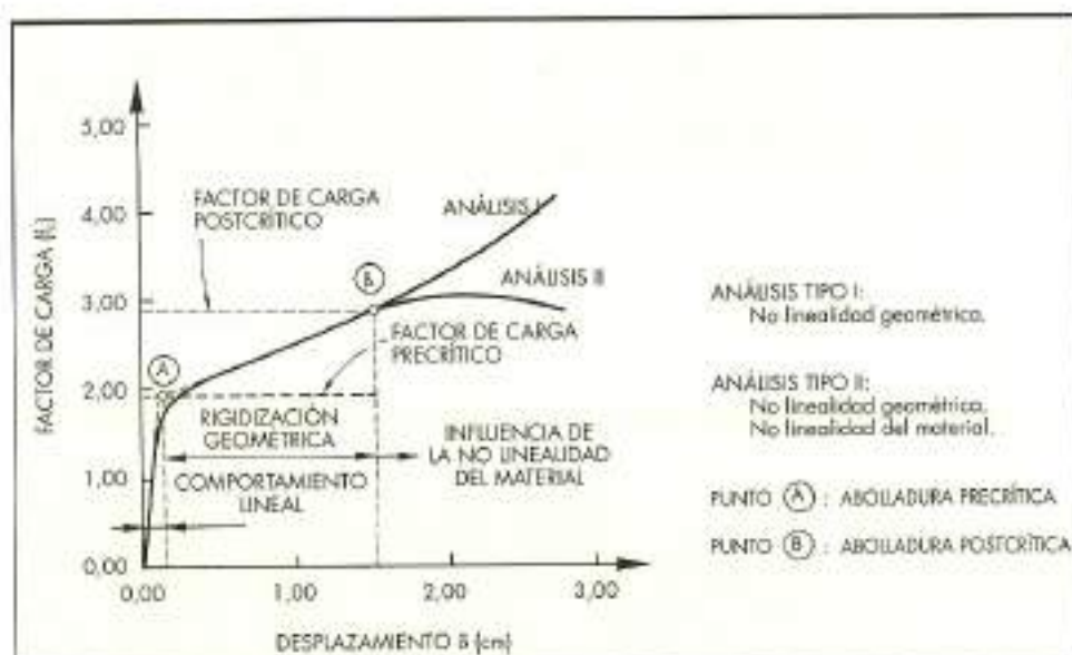
FIGURA 1. Caracterización generalizada del fenómeno de la abolladura (Mirambell y Roca, 1992).
