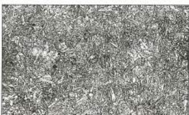
FIGURA 9. Microestructura de martensita revenida en la zona exterior de la barra (500 X).
