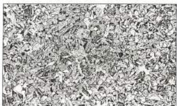
FIGURA 7. Microestructura ferrítico-perlítica en la zona central de la barra (500 X).
