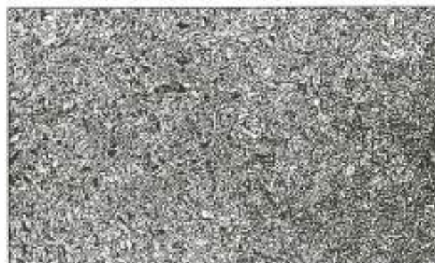
FIGURA 12. Microestructura de bainita revenida en la zona intermedia próxima a la corona exterior (500 X).
