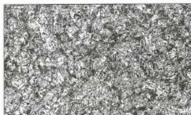
FIGURA 11. Microestructura de bainita revenida y perlita globular en la zona intermedia próxima al círculo central (500 X).
