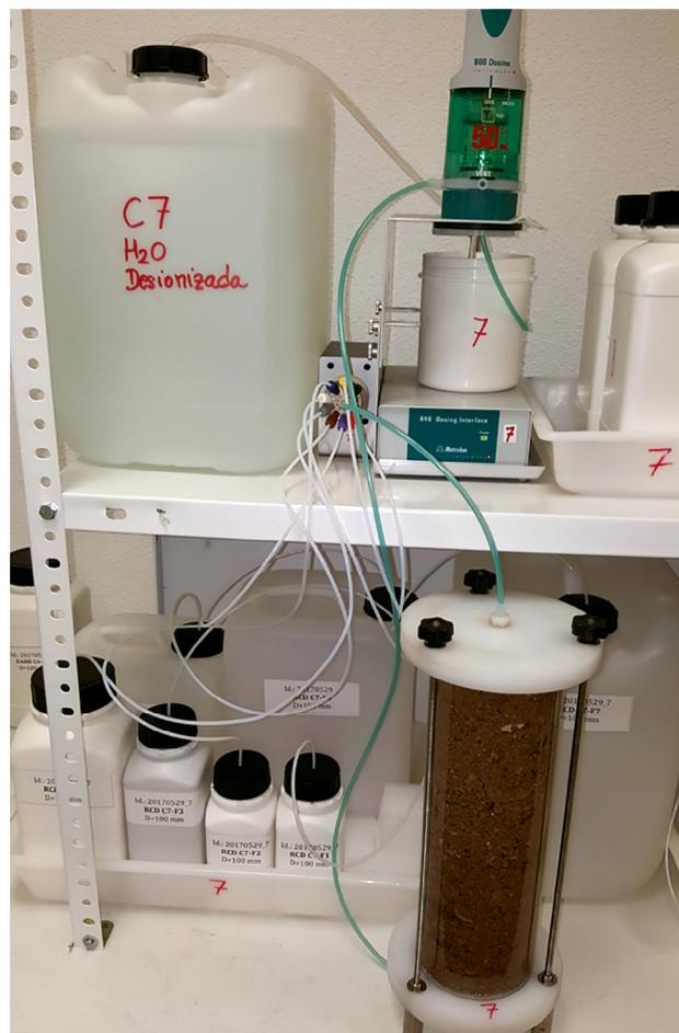
**Foto 2.** Ensayo de lixiviación en columna de RCD (CEN/TS 16637-3:2016).
