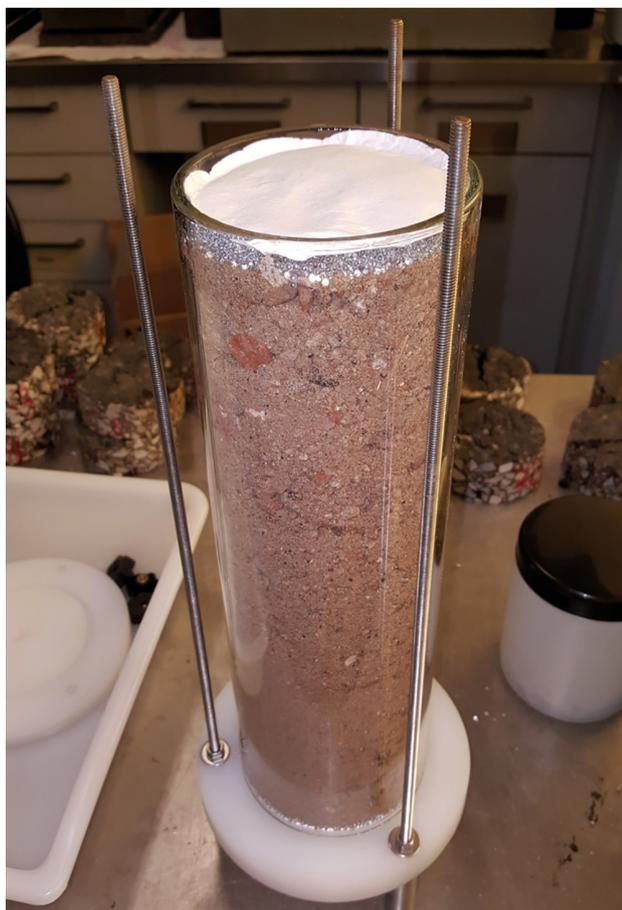
**Foto 1.** Montaje de la columna de RCD para el ensayo de lixiviación (CEN/TS 16637-3:2016).
