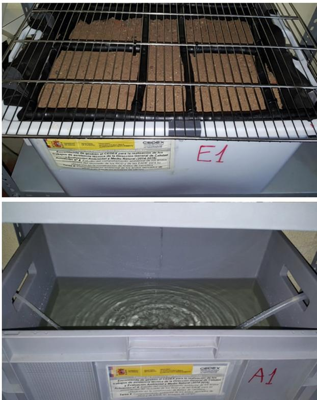
**Foto 3.** Dispositivo para el ensayo de campo (cubeta superior con el material y cubeta inferior para recogida del lixiviado).
