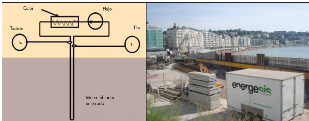
FIGURA 6. Esquema del ensayo de caracterización térmica del suelo y prototipo móvil para realizar medidas de conductividad térmica.
