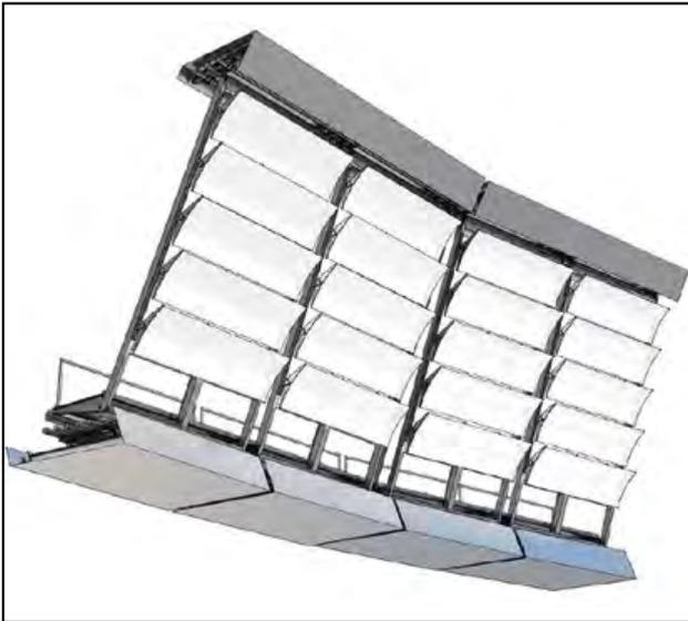
**Figura 15.** Lamas en el anillo de tracción (vista frontal).
