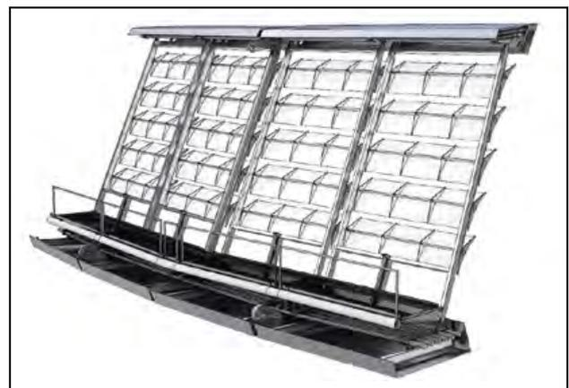
**Figura 14.** Lamas en el anillo de tracción (vista frontal).
