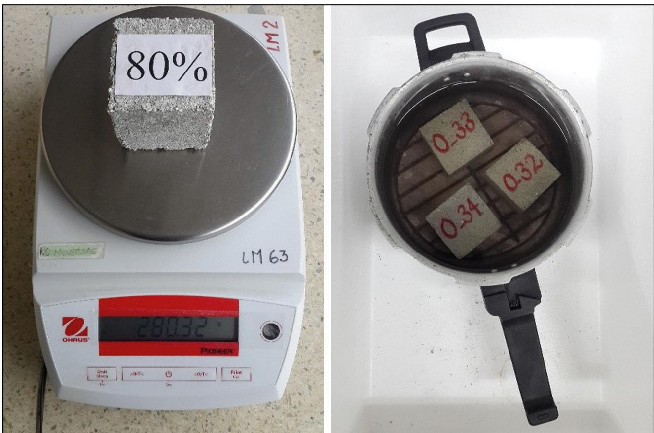
Figura 2. Ensayos de Densidad y Absorción sobre mortero adicionado con porcentajes en volumen de REPS entre 0% y 80%.
