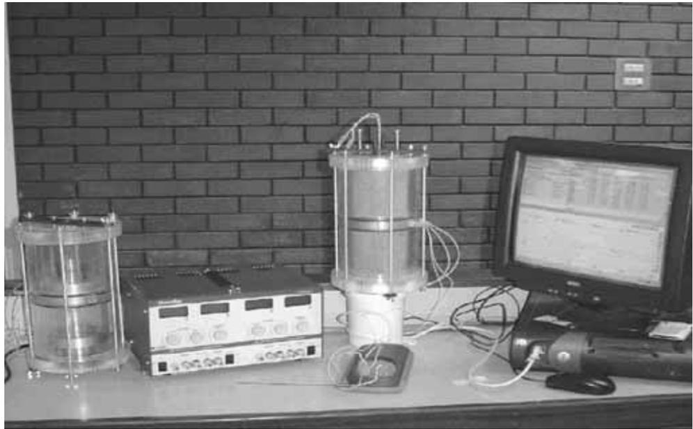
**FIGURA 6.** Equipo para la realización del ensayo de Respuesta Térmica del Terreno en laboratorio desarrollado por Peter Keeton.
